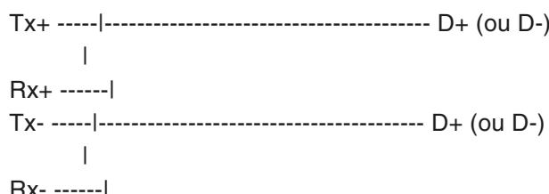
flexotron800 avec communication Modbus
