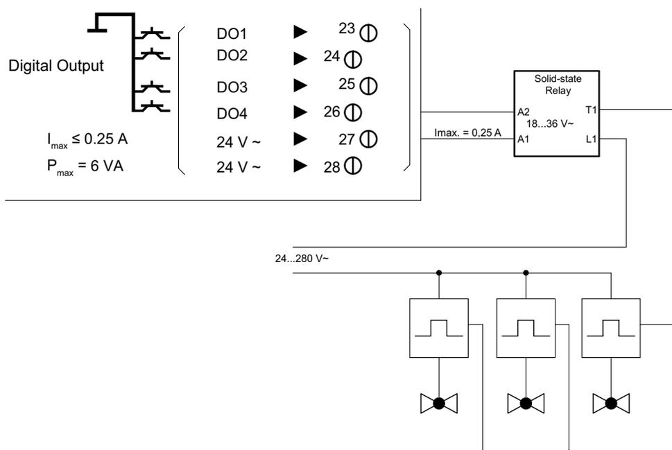
Utilisation de servomoteurs continus pour petites vannes avec positionneur AXS :
